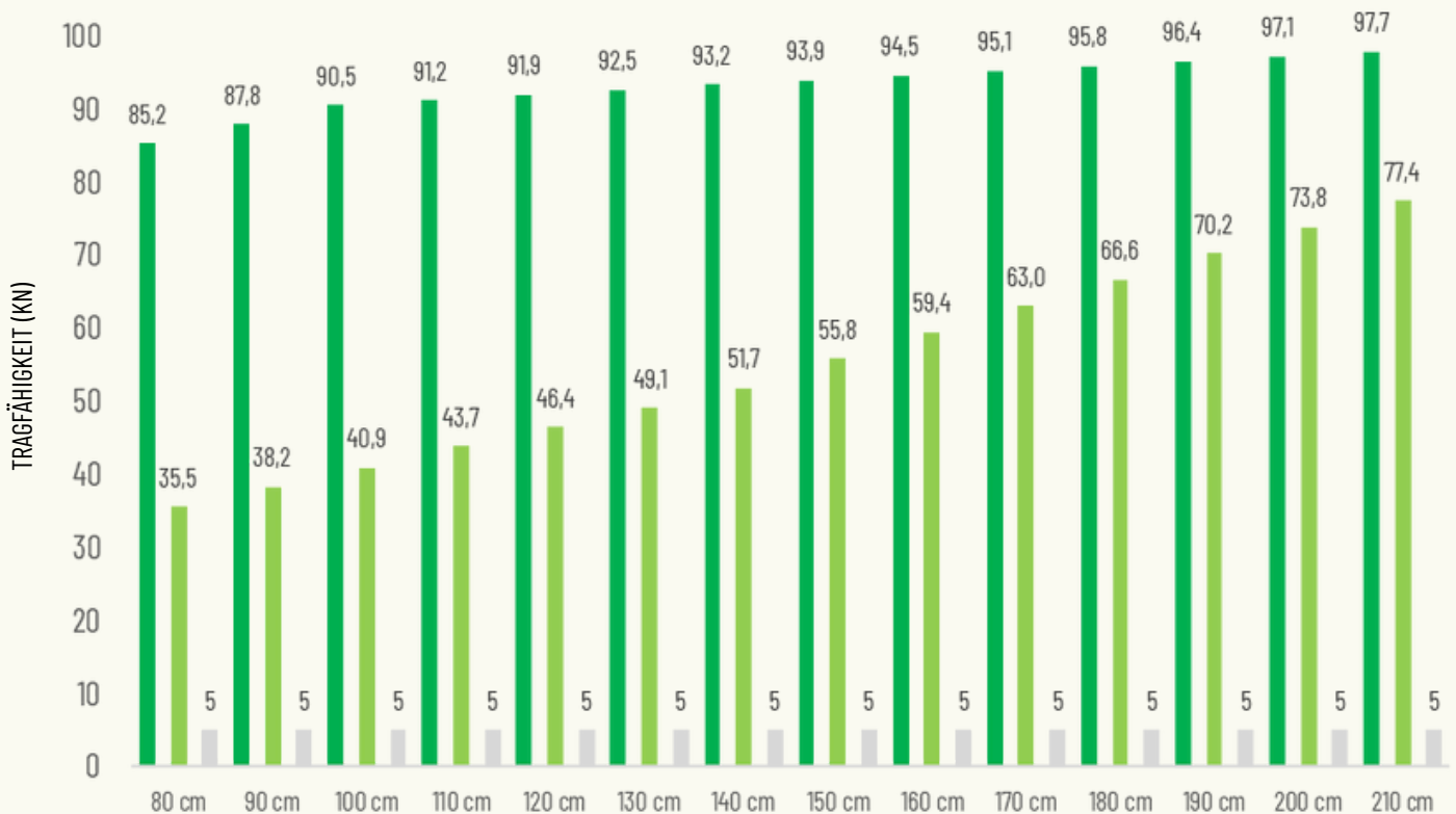
BOHRTIEFE MIT SCHRAUBFUNDAMENTEN IN TRAGFÄHIGER SCHICHT
